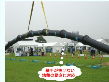
耐震継手管のデモンストレーション (クレーンによる吊り上げ)
